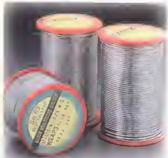
Figura 6.2. Soldadura para electrónica
